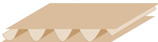
Wird die Welle auf beiden Seiten mit einer glatten Papierbahn verklebt, entsteht einwellige Wellpappe (engl. double-faced corrugated board oder single wall corrugated board).
