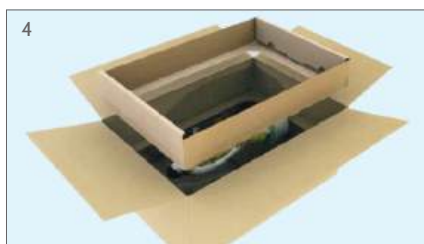
Zweiten Membraneinsatz auf das Packgut legen
