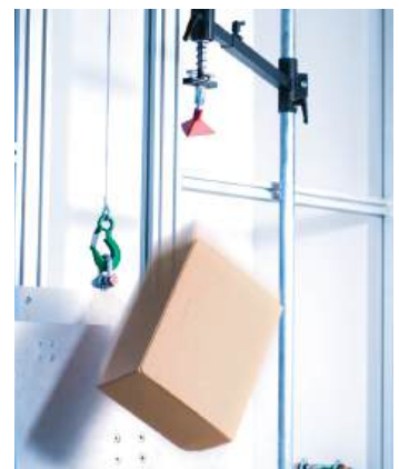
Das DREI V Fallteststudio mit High-Speed-Analyse
